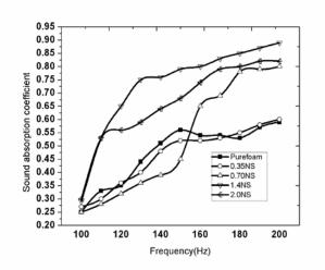
Fig. 8a PU foam with NS
